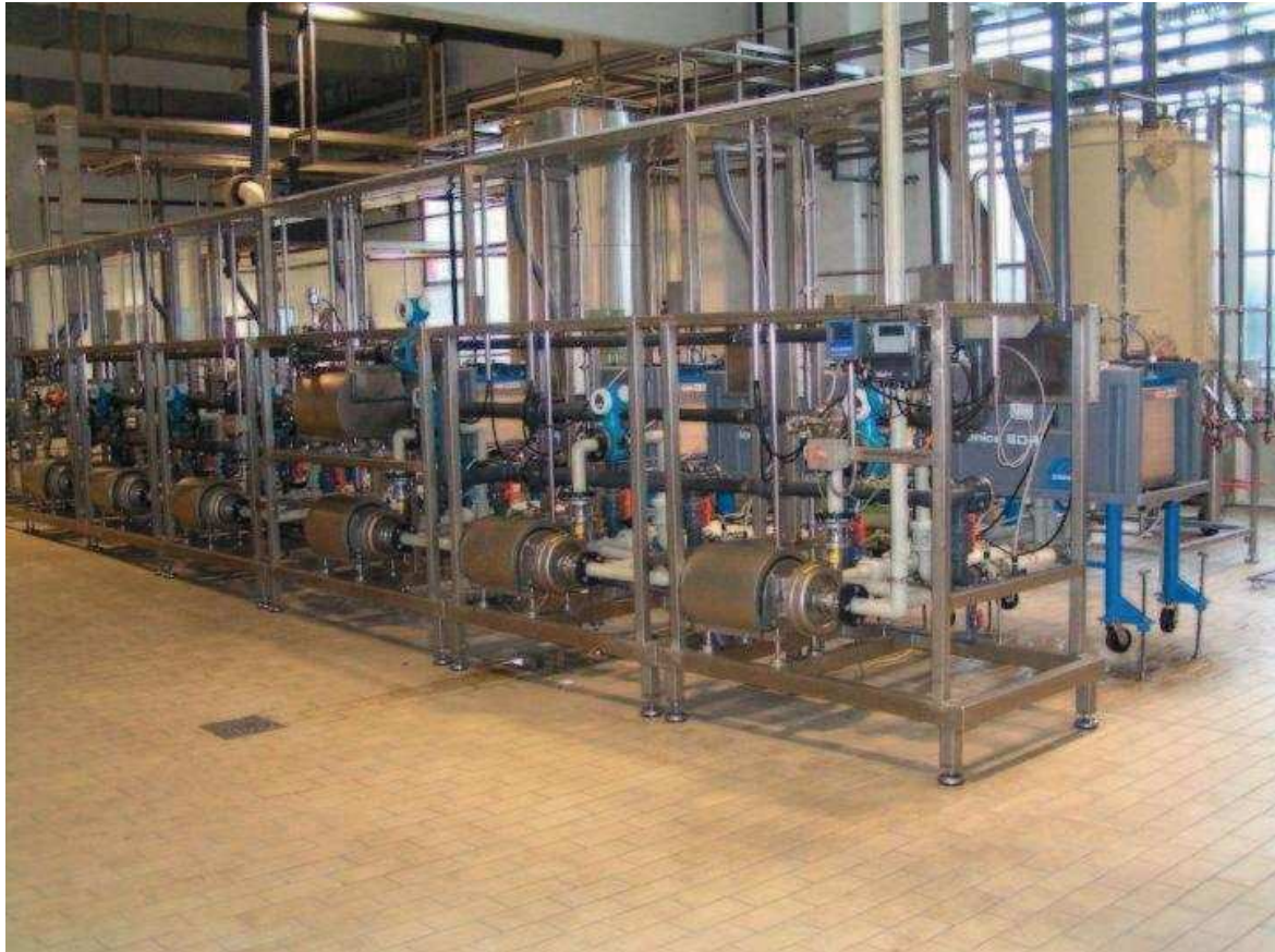
Figura 2: Planta de Electrodiálisis (ED) con pulido por Intercambio iónico (IX)
